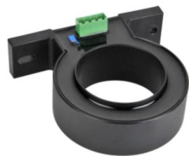
D-FS050LD/60系列直流漏电电流传感器是应用磁调制原理研制而成的一种新型电流传感器，其小电流的稳定性好，初级与次级之间高度绝缘。用于讯号系统、线路检测、漏电监测系统、电流差值测量。
