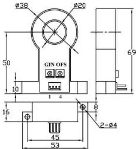
引脚说明： 1 , +15V 2 , -15V 3 , Vout 4 , 0V(电源地) OFS, 零点调节 GIN, 幅度调节
