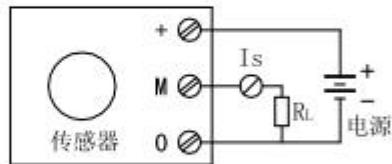
引脚说明: +, 正电源M, 电流输出0, 电源地OFs, 零点调节GIN, 幅度调节
