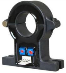
应用霍尔效应的电流传感器，能在电隔离条件下测量交流信号电流。输出和被测电流有效值成比例的 4~20mA 直流电流输出。
