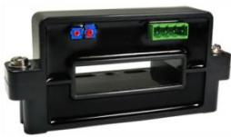
应用霍尔效应的电流传感器，能在电隔离条件下测量交流信号电流，输出和被测电流有效值成比例的4~20mA 直流电流输出。
