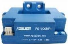
应用霍尔效应开环原理的电流传感器，能在电隔离条件下测量直流、交流、脉冲以及各种不规则波形的电流。
