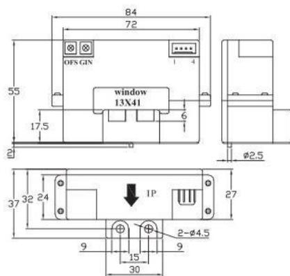
引脚输出: 1, +15V2, -15V3, Vout 4, 0V(电源地)OFS, 零点调节GIN, 幅度调节引线输出: 红, +15V蓝, -15V黄, Vout 黑, 0V(电源地)
