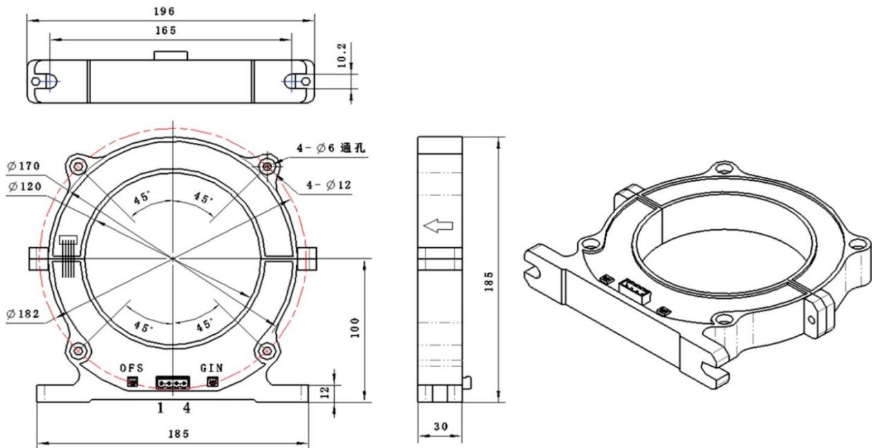
引脚说明：1,+15V 2,-15V 3,Vout 4,0V(电源地) OFS, 零点调节 GIN, 幅度调节
