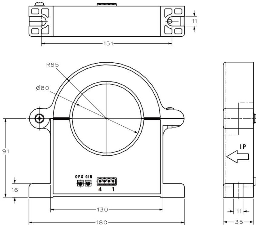
引脚说明：1,+12V 2,-12V 3,Vout 4,0V(电源地) OFS, 零点调节 GIN, 幅度调节
