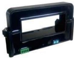
应用霍尔效应开环原理的电流传感器，能在电隔离条件下测量直流、交流、脉冲以及各种不规则波形的电流。
