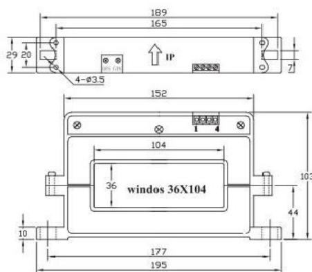
端子输出：1,+15V2,-15V3,Vout 4,0V(电源地)OFS,零点调节GIN,幅度调节引线输出：红,+15V蓝,-15V黄,Vout黑,0V(电源地)
